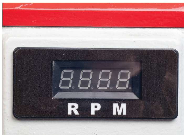
Digitalt display for spindelhastighet
