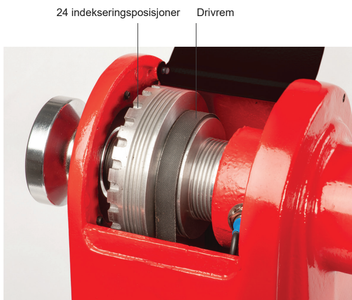
Spindelremskive med 24 indekseringsposisjoner
