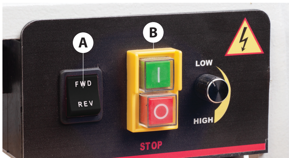
Bryter for forover/revers endrer spindelens dreieretning (A) (IKKE betjen denne bryteren mens dreiebenken er i bevegelse) Av/på-bryter med nullspenningsutløser (NVR) (B)
