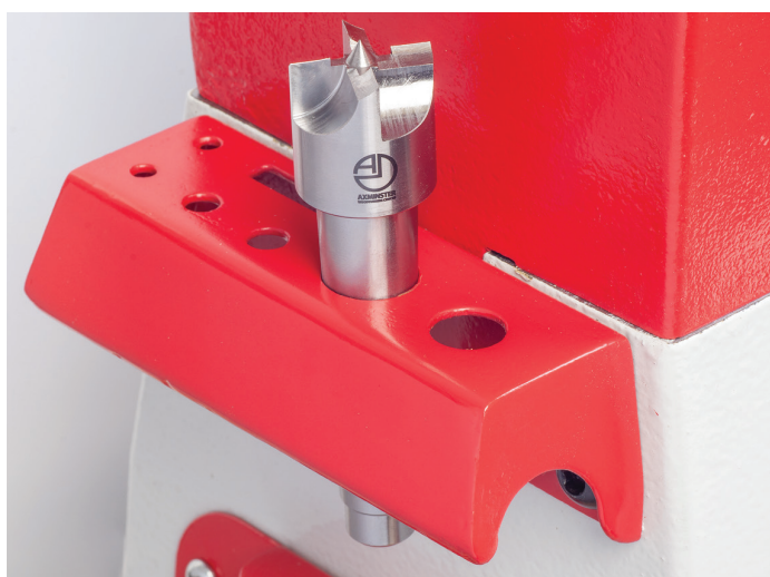
Verktøyholder/bærehåndtak i hver ende av vangen
