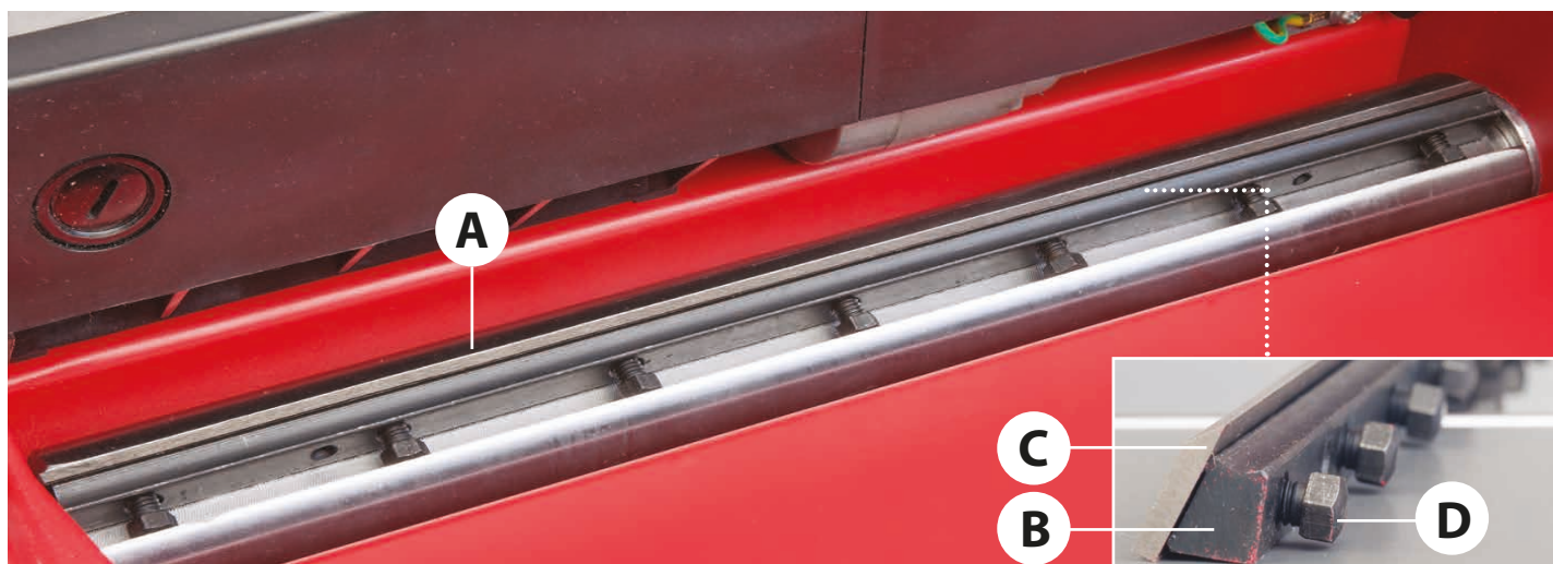
Cutter block (A), Blade holder (B), Blade (C), Square nut (D)
